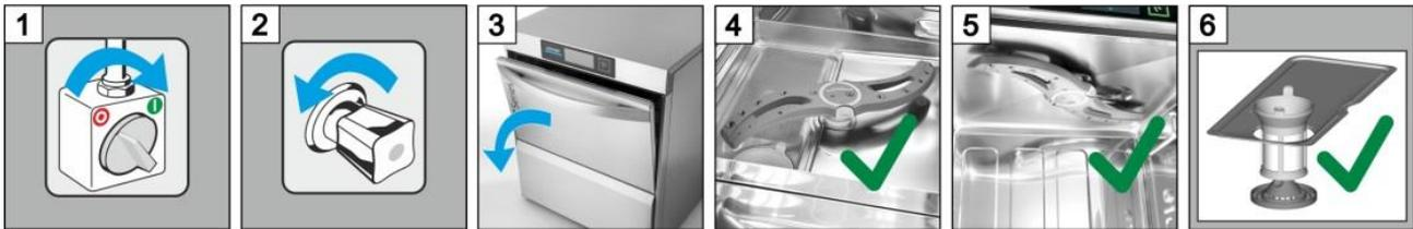
**WICHTIG** Dosiergeräte müssen entlüftet werden, wenn Luft in den Dosierschlauch gelangt ist, weil die Kapseln nicht rechtzeitig ausgetauscht oder nachgefüllt wurden (► 6.3.2).
