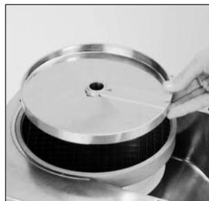
Anschließend die entsprechende Schneidescheibe einsetzen (Scheibe mit gerader Klinge) und diese im Uhrzeigersinn drehen, um sicherzugehen, dass sie richtig sitzt.
