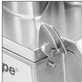
4) Führen Sie die Achse des Scharniers in das Gehäuse an der Rückseite des Blocks ein. Verriegeln Sie den Deckel am Motorblock mit Hilfe des Feststellhakens.
