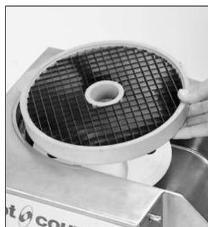
3) Den Aufsatz der Gemüseschneidemaschine auf den Motorblock klappen. Der Feststellhaken muss sich dabei rechts vor Ihnen befinden.
