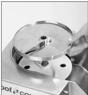
a) **Sie haben eine Reibe -, Streifen - oder Schneidescheibe gewählt.** Stecken Sie die Scheibe auf die Antriebsachse und drehen Sie sie im Uhrzeigersinn, um festzustellen ob sie richtig sitzt.
